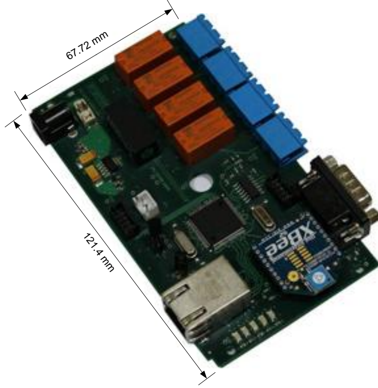
Şekil 1. Elektroduyu™ SN100Xbee Mekanik Özellikleri
